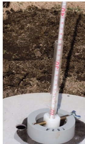
土壌調査中 (透水試験)
